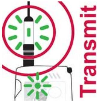
Ist der RT-B77 HELB aktiviert, so blinken die Funktions-LEDs (2) in der Antenne und die Status LED (4) **GRÜN**. Nach der Aktivierung ist der Heulton für etwa 2 Sekunden im Lautsprecher zu hören. Nach weiteren 30 Sekunden wird die Senderkennung über den Lautsprecher ausgegeben. Danach ist alle 30 Sekunden für ca. 2 Sekunden der Heulton des Notsignals im Lautsprecher zu hören.
