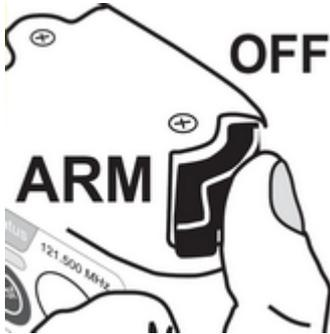
Zum Ausschalten wird der Drehschalter (8) in die Position **OFF** gestellt. Jetzt ist der Notsender RT-B77 HELB ausgeschaltet. Alle Taster oder Kontakte sind außer Funktion. War eine Funktion aktiv, so wird diese mit der Meldung aus dem Lautsprecher: **“Power OFF”** beendet.
