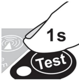
Der Drehschalter (8) ist in Position **ARM**. Drücken Sie jetzt den Taster **TEST** (10) für etwa 1 Sekunde. Der Notsender RT-B77 HELB startet eine Selbsttestroutine. Dabei werden eine Anzahl elektronische Betriebsparameter überprüft und der Zustand der Batterien überprüft.
