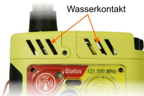
Wird der Notsender RT-B77 HELB für mehr als 10 Sekunden von Wasser umspült, so schaltet er sich automatisch ein. Dafür ist es notwendig, dass die beiden Kontakte hinter den Abdeckungen durch Wasser überbrückt werden.
